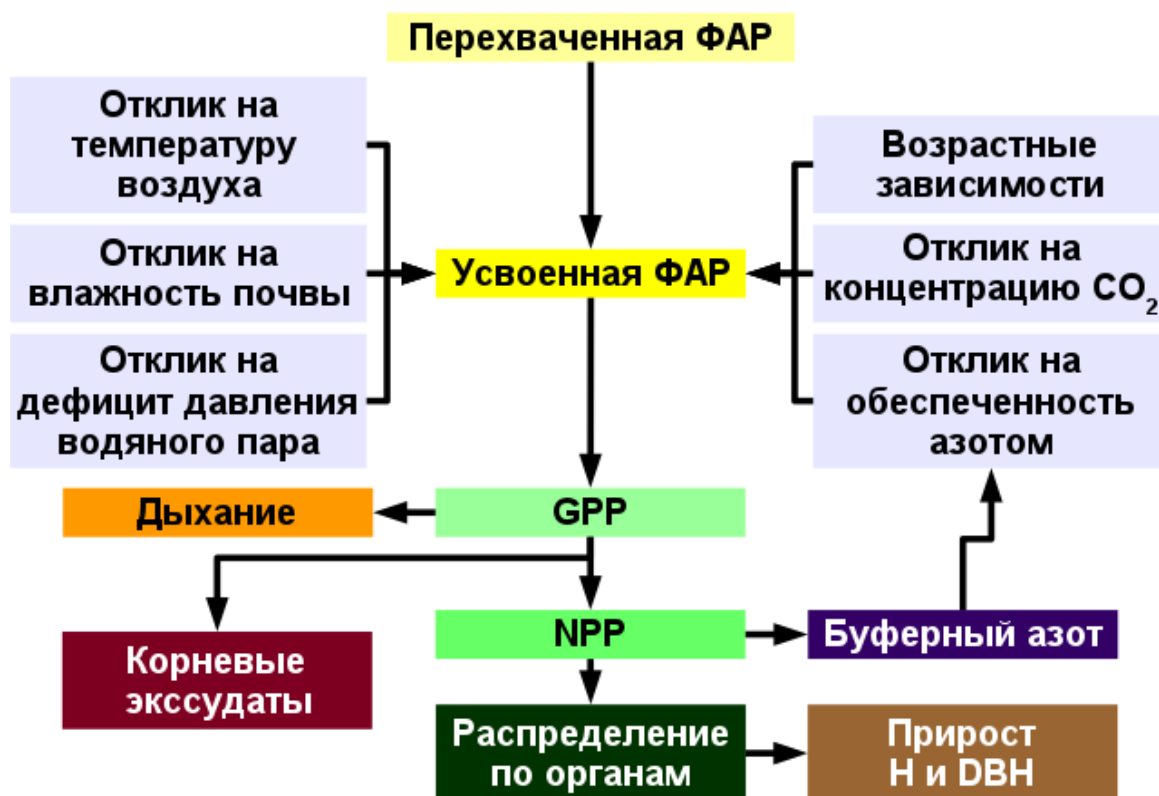
Рис. 1. Блок-схема годового шага модели. Здесь GPP – это валовая первичная продукция, NPP – чистая первичная продукция, H – высота дерева, DBH – диаметр ствола дерева на высоте 1.3 м, ФАР – фотосинтетически активная радиация.
